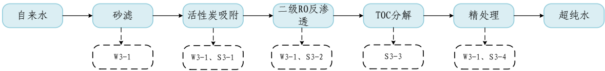
图 2-11 超纯水制备工艺流程图
