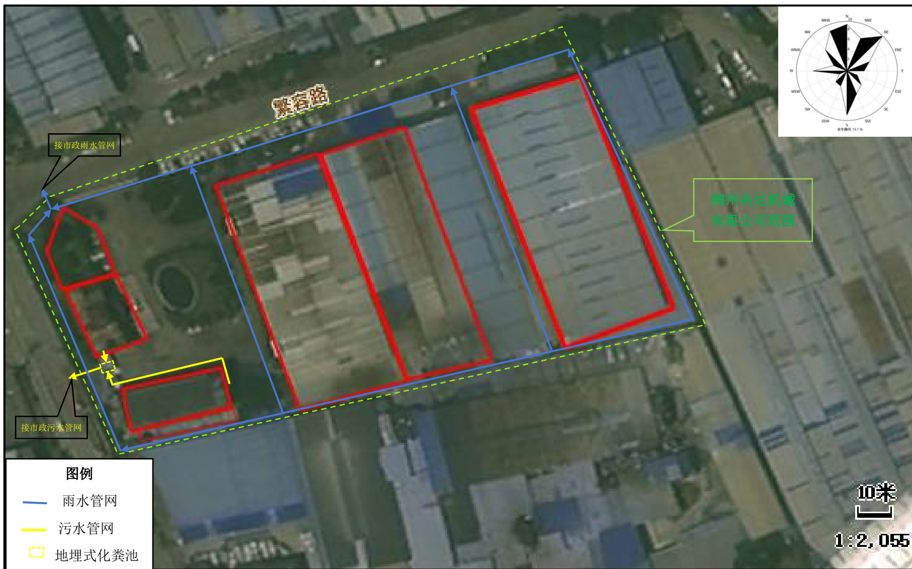
附图 3-3 项目总平面布置图——雨污水管网走向图
