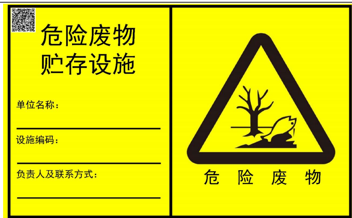
图 4-3 危险废物贮存设施标志（横版）
